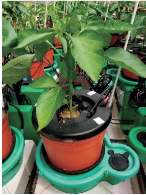
图1 位于温室中的称重栽培花盆。使用四个滴头提供水与营养，通过塑料盖限制水分蒸发。把花盆装到一个绿色塑料容器中，收集预先确定的排水量。花盆和塑料容器放置在电子秤上，电子秤与PlantArray 3.0系统相连
